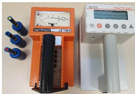
1 Am-241 Präparat, 1 Sr-90 Präparat, 1 Cs-137 Präparat, Großflächenproportionalzählrohr
