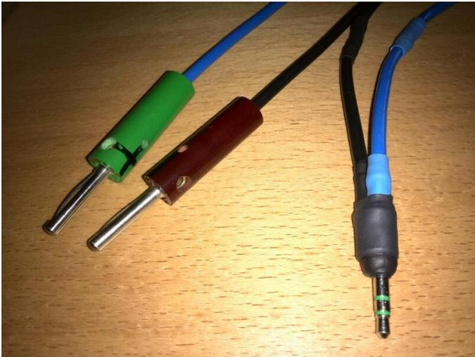
Den 3,5 mm Klinkenstecker (rechts in obiger Abbildung) wird wie ein gewöhnliches aufnahmegerät in den Mikrofon-Port (rosa) der Soundkarte ggf. je nach Beschaffenheit des PCs, des Mainboards eingesteckt. Jetzt ist das Geiger- Müller- Zählrohr physikalisch verbunden.
